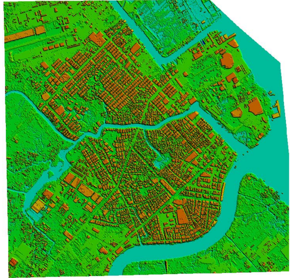
Hình 3. Mô hình số cao độ được sử dụng trong mô hình Mike Urban với các lớp nhà và đường
