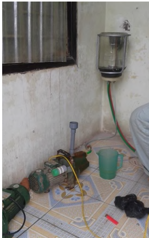
Hình 1: Bình điều tiết ống Xi phong do ông Ngô Quốc Vương, trưởng trạm thủy văn Triều Dương nghiên cứu chế tạo
