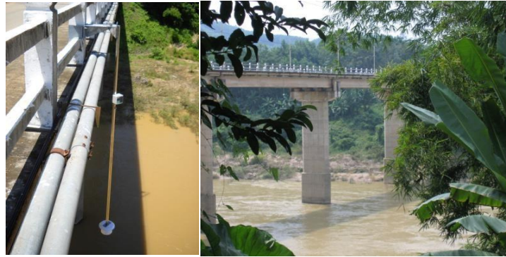
Hình 2. Cảm biến siêu âm được lắp đặt tại cầu Hiệp Đức - Quảng Nam
