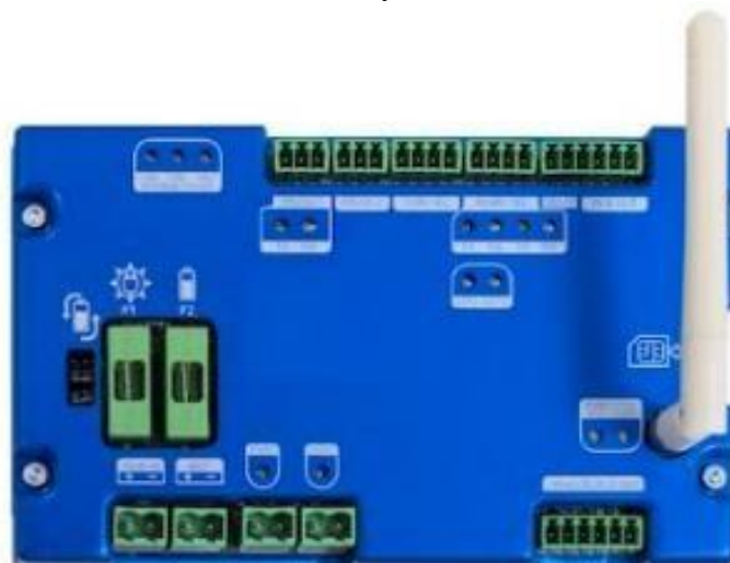
Hình 6. Thiết bị thu thập xử lý số liệu và truyền tin iDL-150
