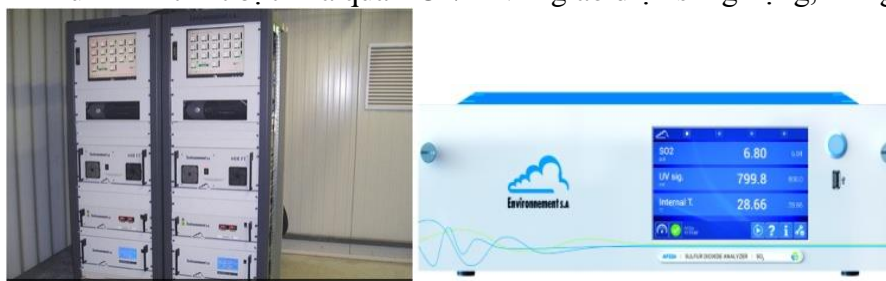
Hình 43. Hệ thống quan trắc sử dụng công nghệ Module phân tích khí
