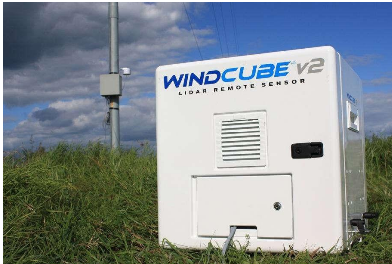
Hình 3. Thiết bị đo gió phân tầng theo nguyên lý lidar
