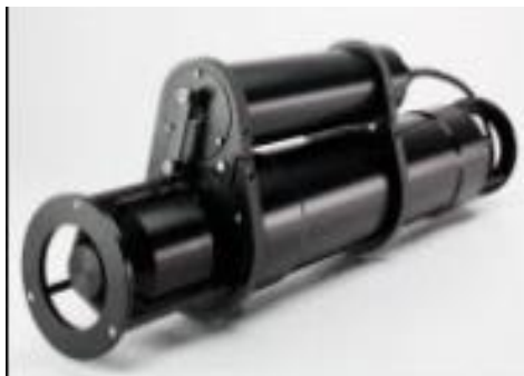
Hình 36. Máy LISST-25X đo hàm lượng phù sa lơ lửng
