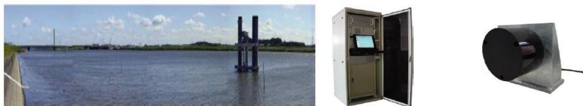
Hình 34. Hệ thống đo lưu lượng dòng chảy ATENAS đối với sông rộng
