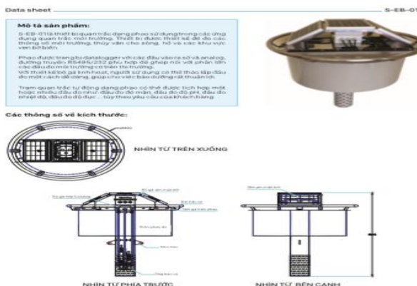
Hình 41. Công trình đo nhiệt muối trên phao
