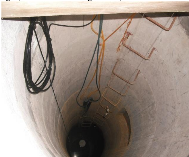
Hình 1. Đầu dò áp lực được đặt bên trong giếng hoặc bờ sông
