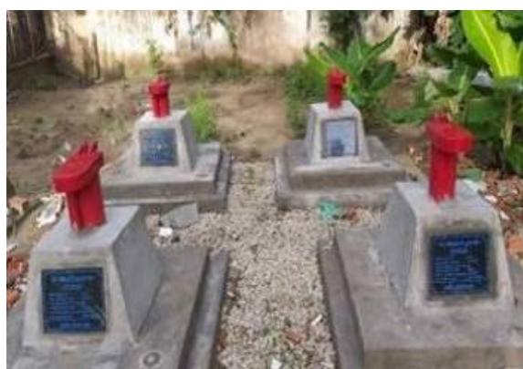
Hình 9. Trạm quan trắc bán tự động nước dưới đất tại Phường 1, thị xã Giá Rai, tỉnh Bạc Liêu
