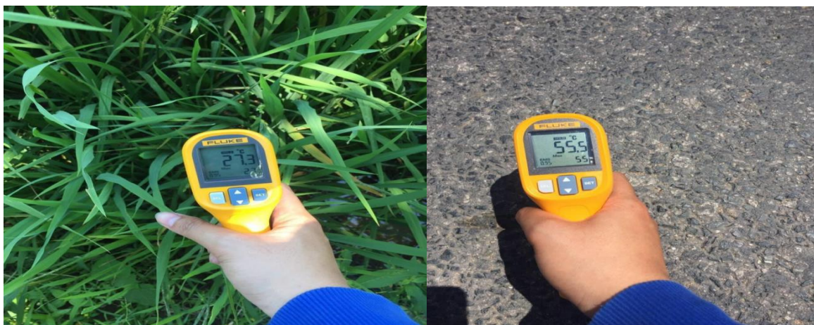
Hình 7. Đo nhiệt độ tại các lớp phủ bề mặt ở thành phố Long Xuyên năm 2022.
